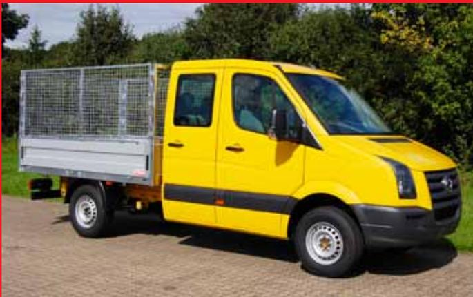
Typ TA mit Ausführung Gitteraufsatz 1000 mm hoch.
