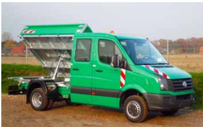
Dreiseitenkipper Typ DK mit Ausführung Stahlbordwände.
