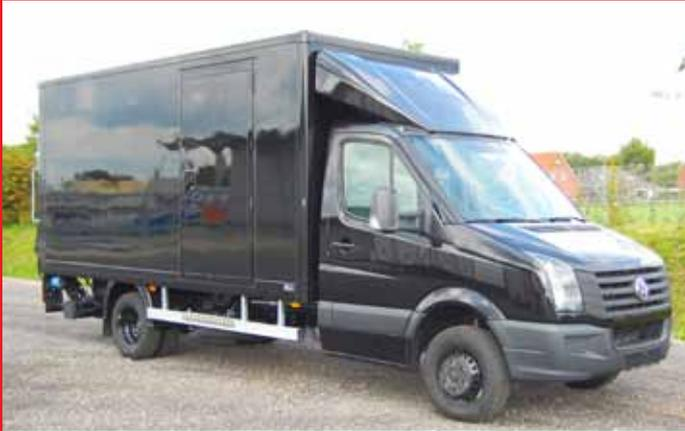
LBK-Sandwichkofferaufbau mit 3-D GFK-Dachspoiler.
