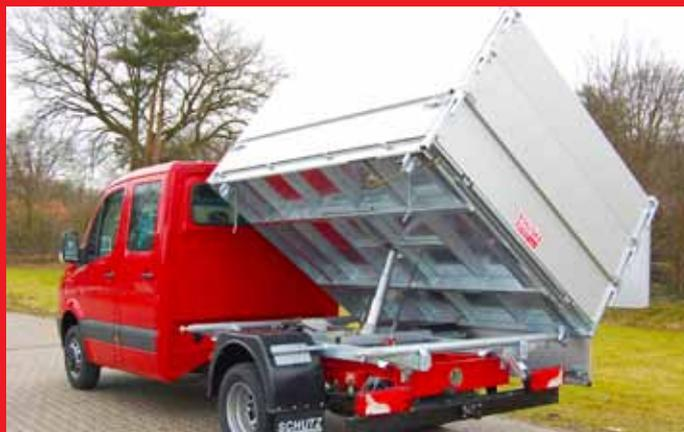
Dreiseitenkipper mit Ausführung Alu-Pendelaufsatz 400 mm.
