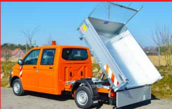
Spezielle Kipperbordwände mit oberer Verstärkung.
