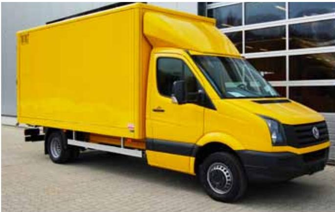
LBK-Sandwichkoffer mit 3D-Dachspoiler und Lackierung.
