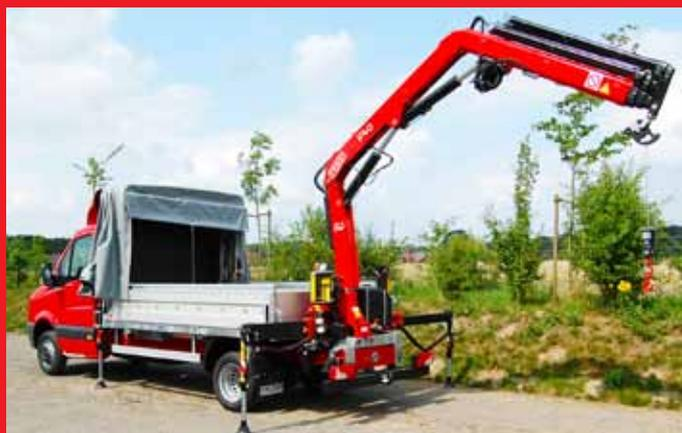
Heckkran F 40 zum Beladen von Fahrzeug und Anhänger.
