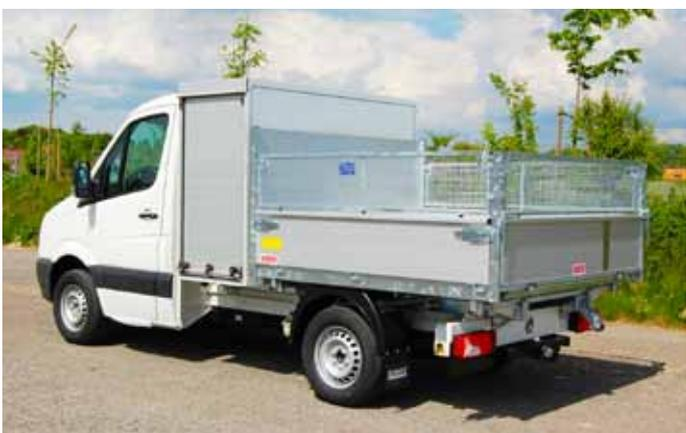
Ausführung mit Rollo-Werkzeugschrank und verkürzten Aufbau.
