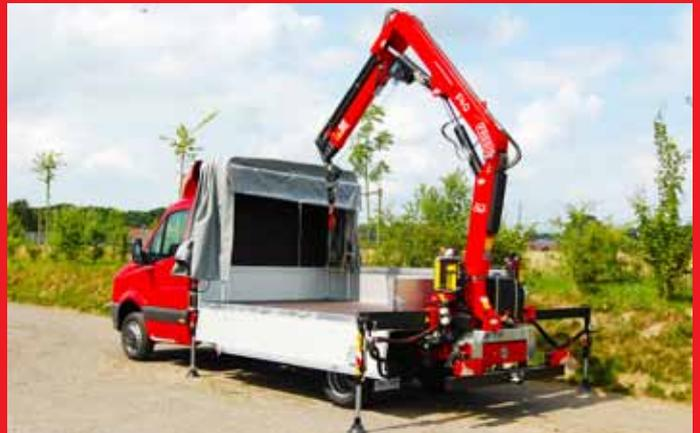
Ausführung mit Heckladekran und schiebarem Planengestell.
