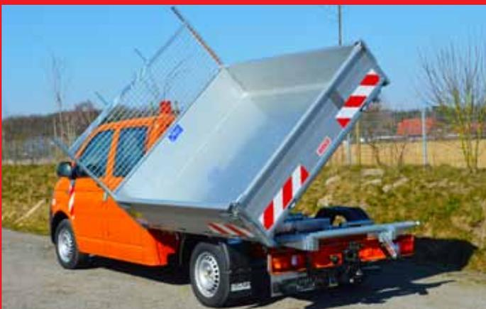
Dreiseitenkipper Typ DK mit feuerverzinktem einteiligen Boden.
