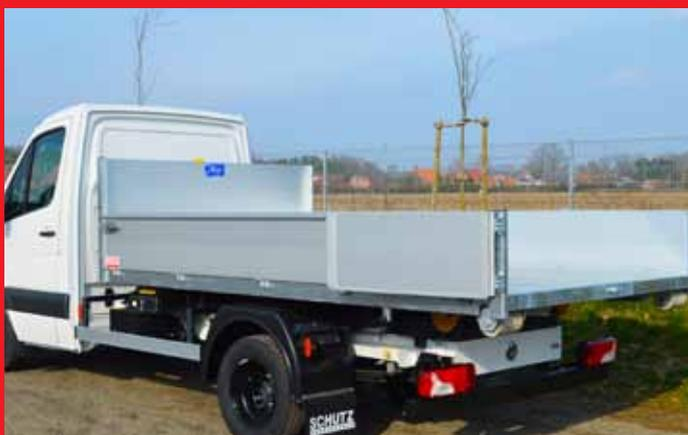
Pritschenausführung mit Heckklappentür.
