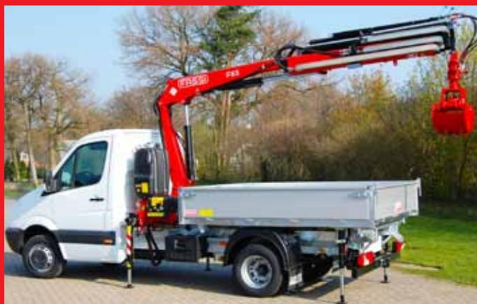
Fassi Knickarmkran F 20 - 40 mit Drehservo und Greiferbetrieb.
