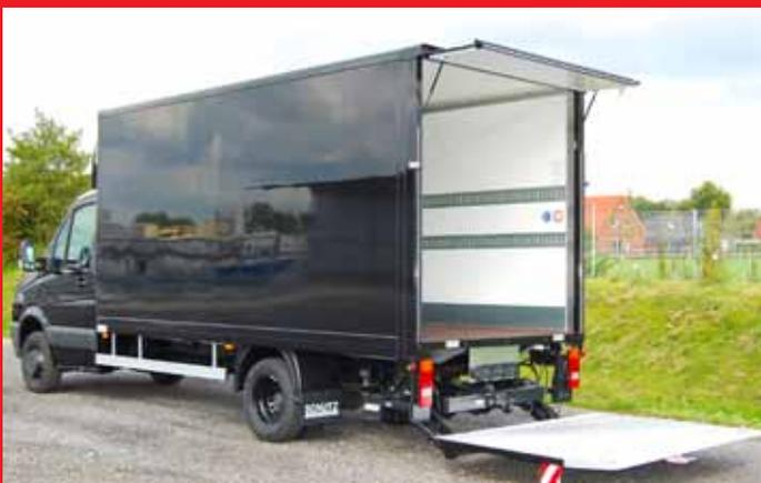
2 Reihen versenkte Kombi-Zurrschienen und Aluscheuerleisten.
