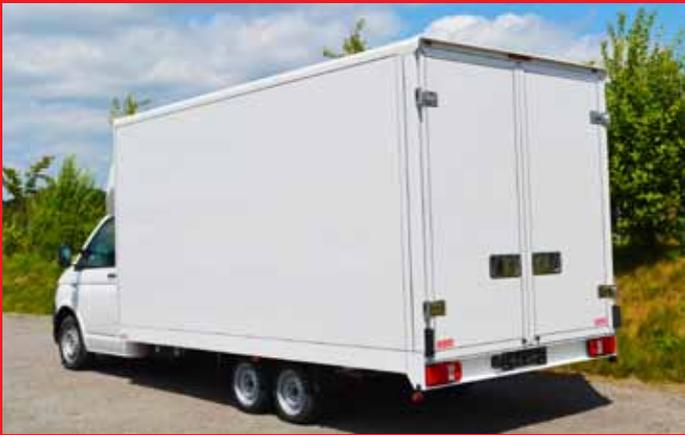
Ausführung mit heckseitigen Sandwich-Doppelflügeltüren.
