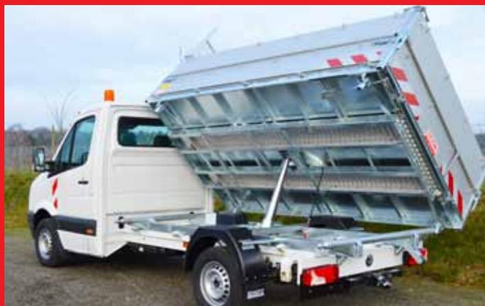
Ausführung mit Aluaufsatz und integrierten Alu-Auffahrschienen.
