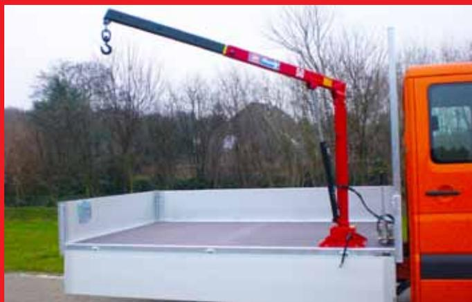
Manueller Teleskopkran mit max. 500 kg Tragkraft.
