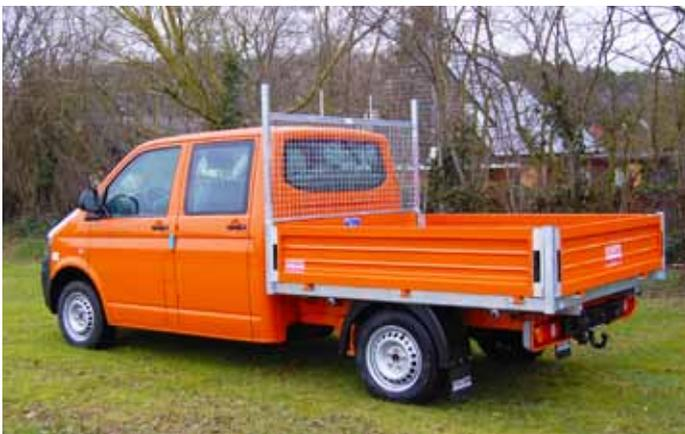
Ausführung mit Stahlbordwänden und Stirnwandgitter.
