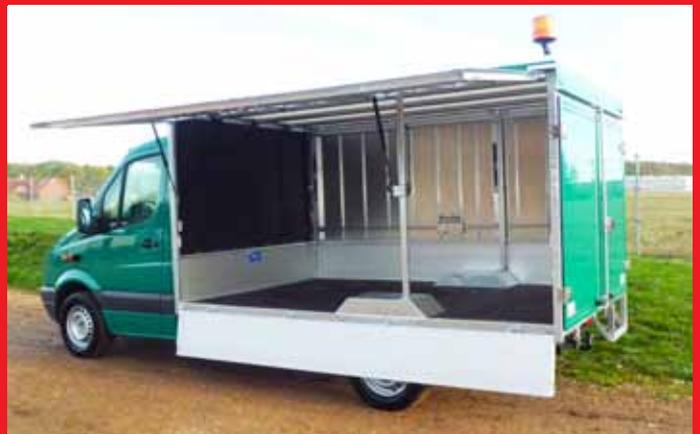
Ausführung mit Planengestell und Seitenklappe
