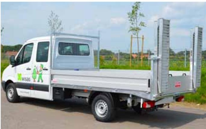
Ausf. mit Heckabschrägung und klappbaren Auffahrschienen.
