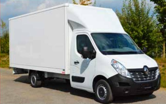
Leichtbaukofferaufbau LBK mit verlängertem Überhang.
