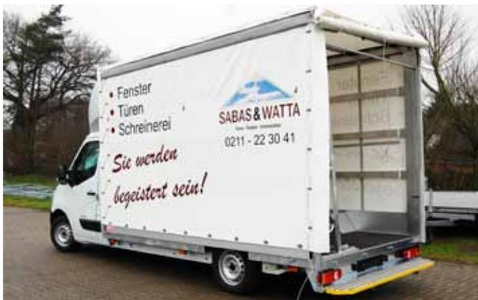
Flachbodenpritsche mit Schiebeleiste und Heckauftritt.
