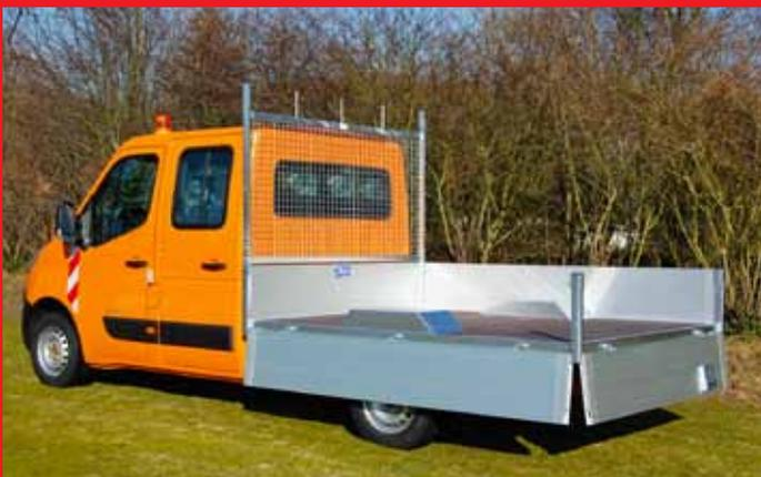
Tiefpritsche Typ TA mit abklappbaren Alubordwänden, eloxiert.
