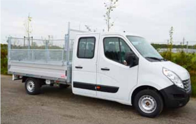
Ausführung mit abklappbaren Gitteraufsatz 1000 mm.
