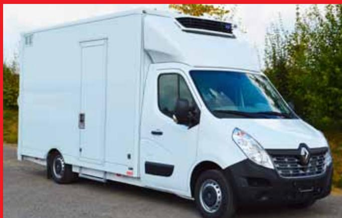
SWK-Flachbodenisokoffer mit Seitentür und Kühlmaschine.
