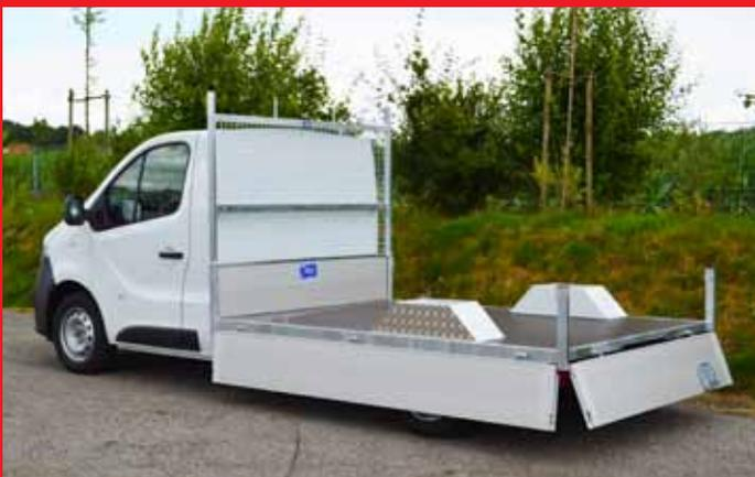
Tiefpritsche Typ TA mit abklappbaren Alubordwänden.
