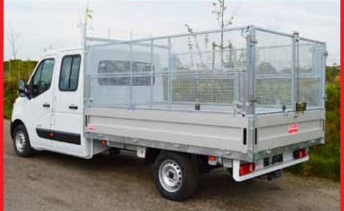
Stirnwandschutzgitter mit Leiteraufsatz und Laubgitteraufsatz.
