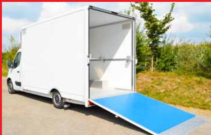
Rutschfeste Auffahrrampe mit Gasdruckdämpfer Unterstützung.
