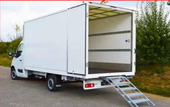
Leichtbaukofferaufbau LBK mit ausziehbarer Hecktreppe.
