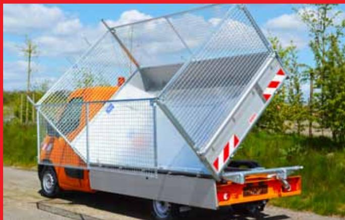
Der Gitteraufsatz ist pendelnt gelagert und herausnehmbar.
