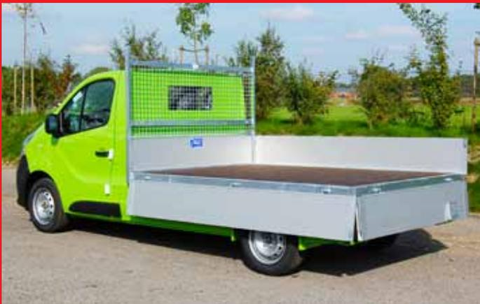
Mittelhochpritsche Typ M mit abklappbaren Alubordwänden.
