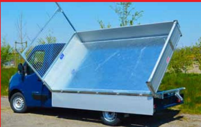
Dreiseitenkipper Typ DK mit feuerverzinktem einteiligen Boden.
