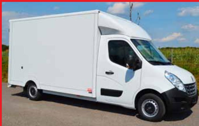
Flachbodenkoffer leicht isoliert mit 3D-Dachspoiler.
