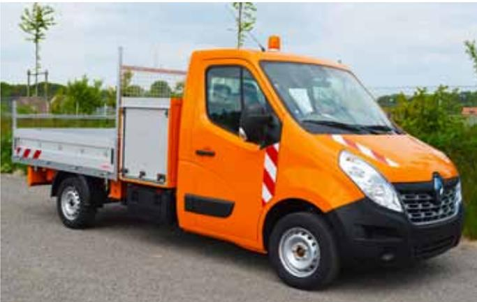
Ausf. vorn verkürzt und Materialschrank mit Aluminium-Rollo.
