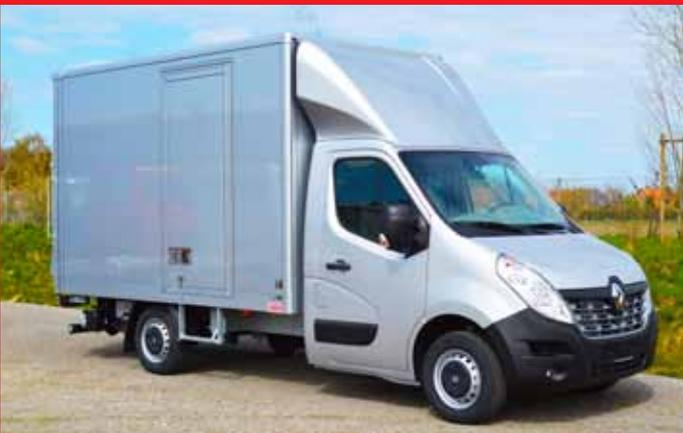
Leichtbaukofferaufbau LBK mit Seitentür und 3D-Dachspoiler.
