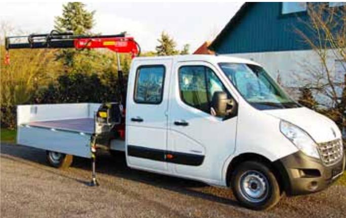
Ausführung mit Ladekran Fassi Micro 20 vor Pritschenaufbau.
