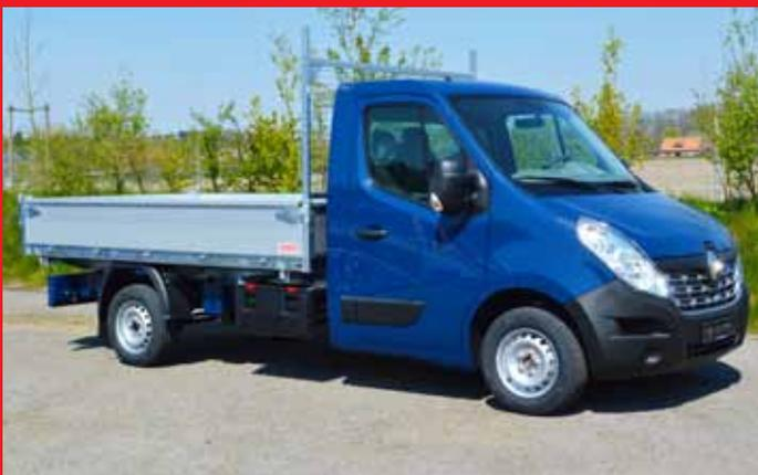
Spezielle Kipperbordwände mit oberer Verstärkung.
