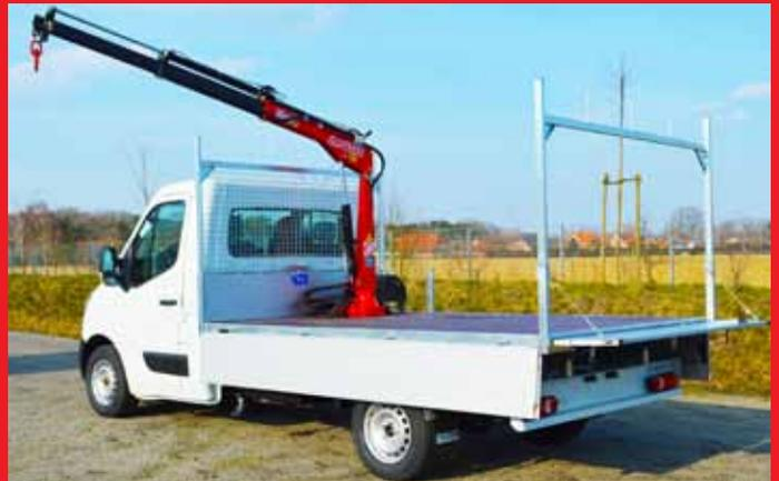
Ausf. mit integriertem Teleskop-Ladekran und Leiterträger.
