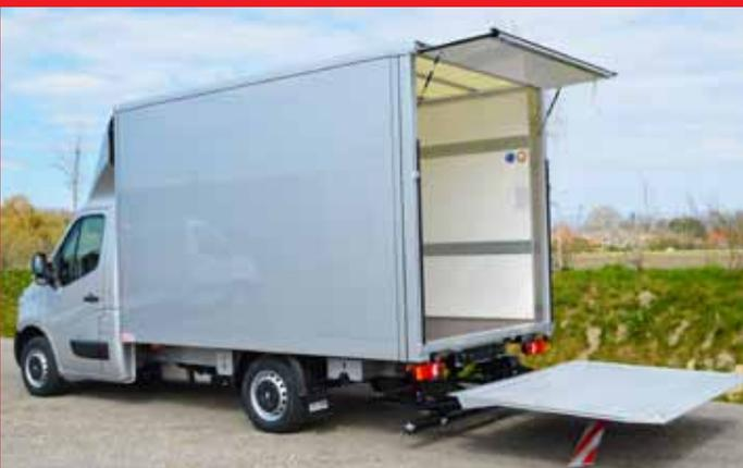
Hydraulische Ladebordwand 750 kg mit Heckoberklappe.
