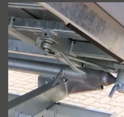
✓ Zentralverschluß für bequemes Öffnen der Heckklappe
