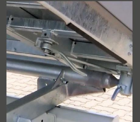
✓ Zentralverschluß für bequemes Öffnen der Heckklappe
