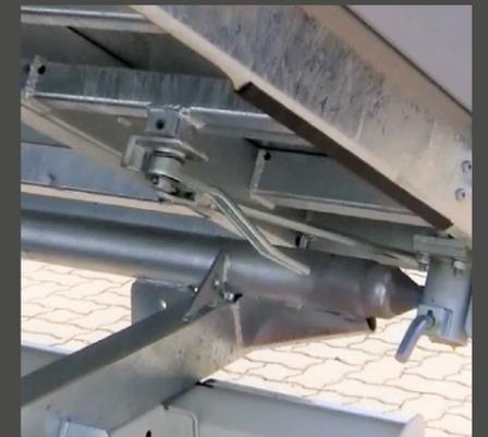
✓ Zentralverschluß für bequemes Öffnen der Heckklappe
