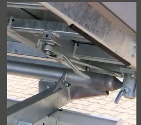
✓ Zentralverschluß für bequemes Öffnen der Heckklappe
