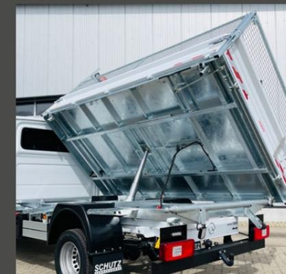
✓ Extrem robuste Unterkonstruktion und hochwertige Hydraulikkomponenten
