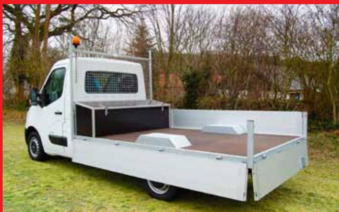
Tiefpritsche Typ TA mit abklappbaren Alubordwänden, eloxiert.
