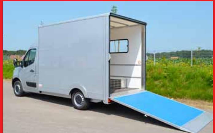
LBK-Flachbodenkoffer und Auffahrrampe mit Gasdruckdämpfer.
