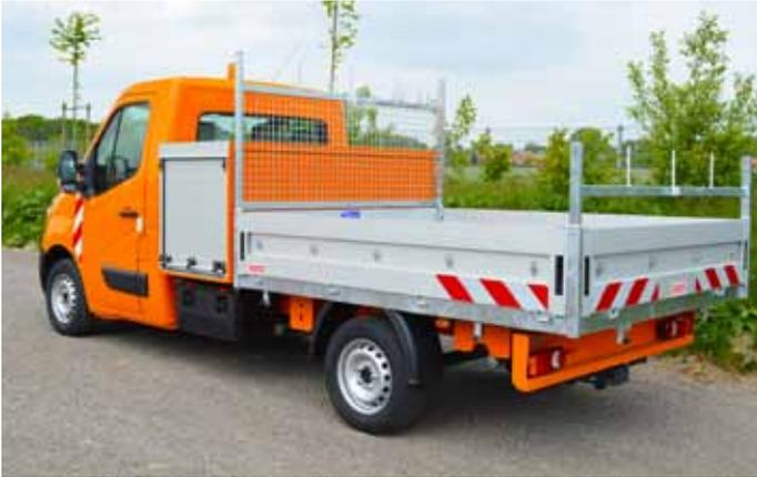
Ausführung mit Werkzeugbox, Stirnwandgitter und Leiteraufsatz
