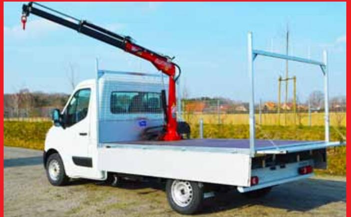
Ausf. mit integriertem Teleskop-Ladekran und Leiterträger.
