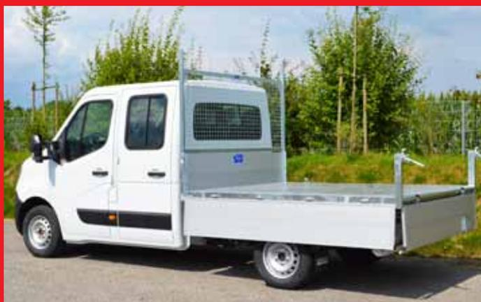
Spezielle Kipperbordwände und hintere Pendelverschlüsse.
