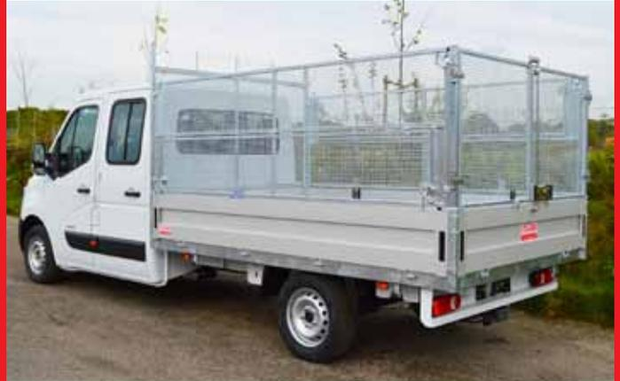
Stirnwandschutzgitter mit Leiteraufsatz und Laubgitteraufsatz.
