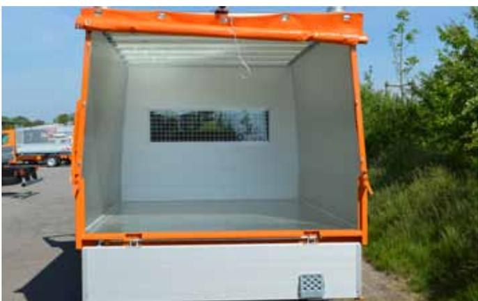
Schnell zugänglich mit hinter Rollplane, federbelastet.
