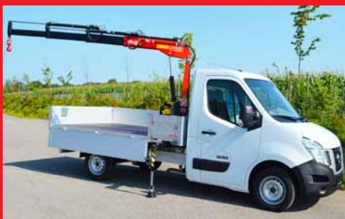
Mittelhochpritsche Typ M mit Ladekran in Pritsche integriert.
