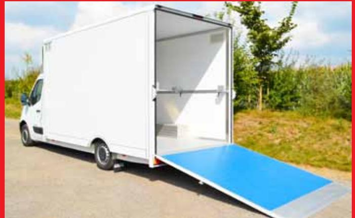
SWK-Flachbodenkoffer isoliert mit Auffahrrampe.
