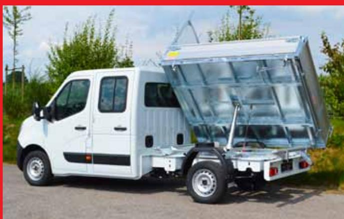
Dreiseitenkipper Typ DK mit feuerverzinktem einteiligen Boden.
