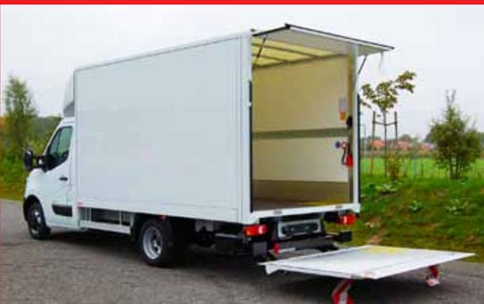
Hydraulische Ladebordwand 750 kg mit Heckoberklappe.
