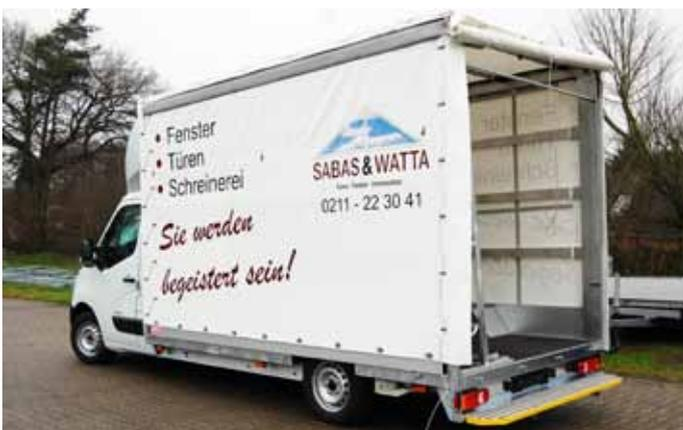
Flachbodenpritsche mit Schiebeplane und Heckauftritt.
