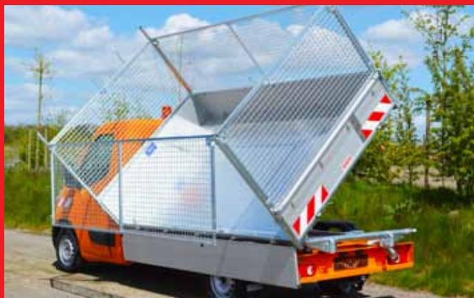
Ausführung mit pendelnt gelagerten Gitteraufsatz 1000 mm
