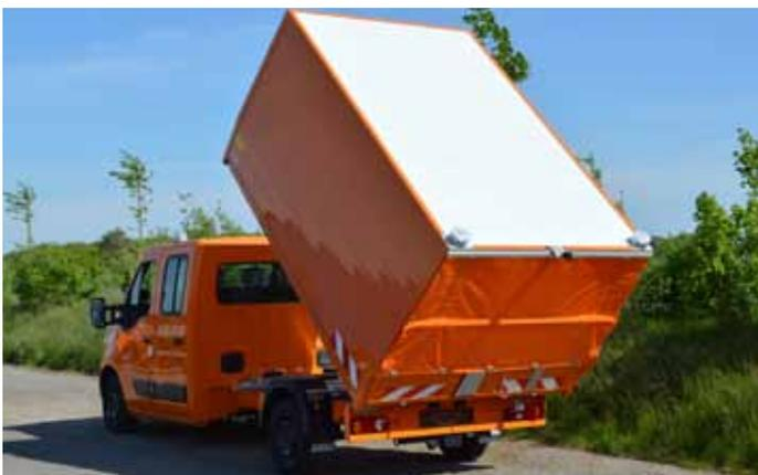
Ausführung für den Hächseinsatz mit festem GFK-Dach.
