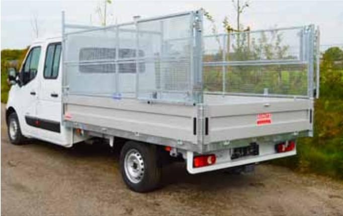
Ausführung mit abklappbaren Gitteraufsatz 1000 mm.
