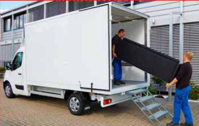
Leichtbaukofferaufbau LBK mit ausziehbarer Hecktreppe.
