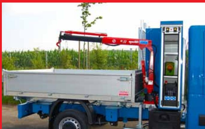
Ausführung mit Werkzeugschrank und 500 kg Ladehilfe.
