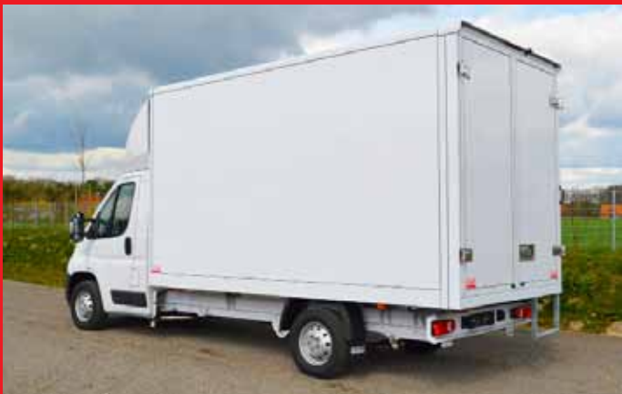
LBK-Sandwichkoffer mit Standardausführung „Hecktüren“.
