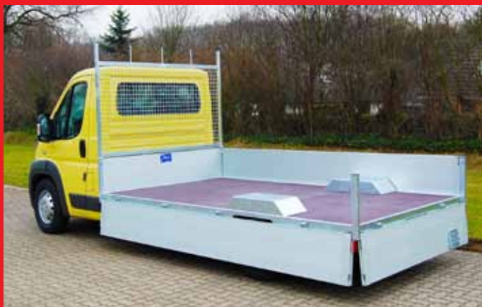
Tiefpritsche Typ TA mit Radkästen, komplett feuerverzinkt.
