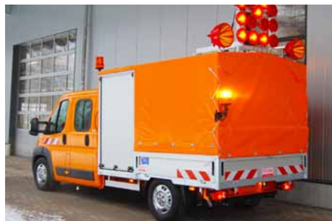
Ausführung mit RKL, Vorwarnblitzer und Schwenkleuchtpfeil.
