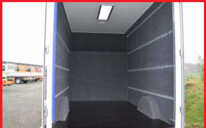
Versenkte Stableisten und Nadelfilz-Auskleidung.
