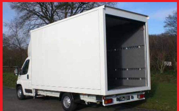
3 versenkte Stäbchenzurrlasten und Nadelfilzauskleidung.
