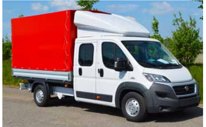
Werkspritsche mit Planengestell und 3D-Dachspoiler für Doka.
