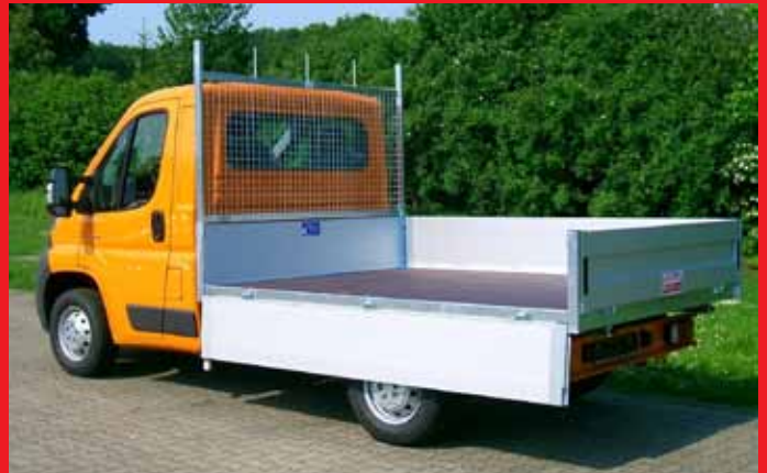
Mittelhochpritsche Typ M ohne Radkästen, kompl. feuerverzinkt.
