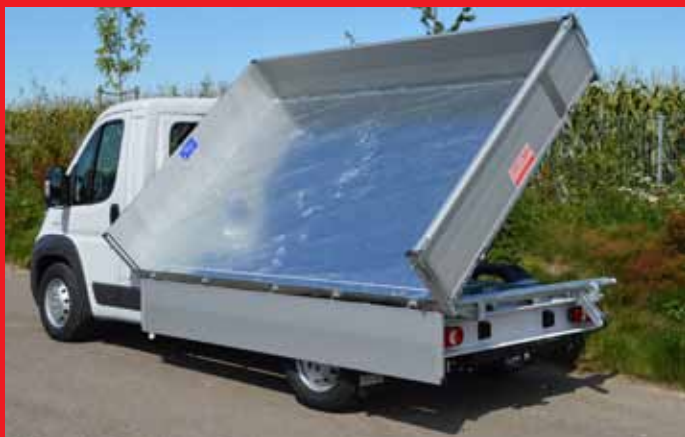
Dreiseitenkipper Typ DK mit feuerverzinktem einteiligen Boden.
