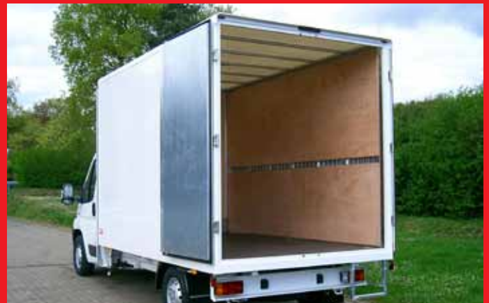
ALK-Alukofferaufbau mit Innenverkleidung 6 mm Sperrholz.
