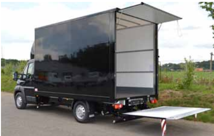
LBK-Sandwichkofferaufbau mit 750 kg Ladebordwand.
