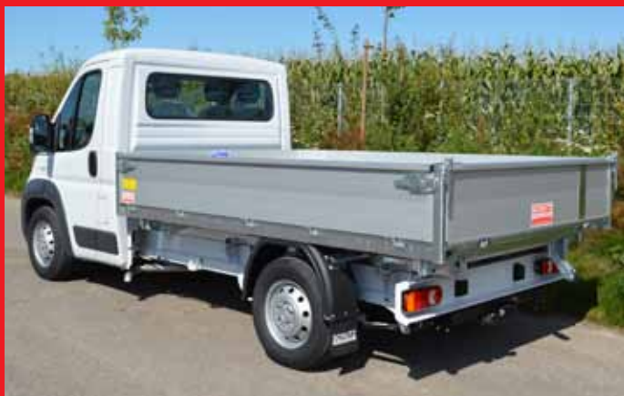
Spezielle Kipperbordwände mit oberer Verstärkung.
