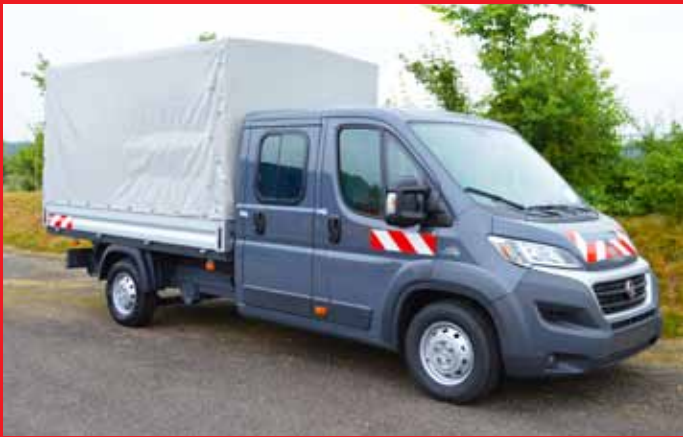
Werkspritsche mit Planengestell und Warnmarkierungsfolie.
