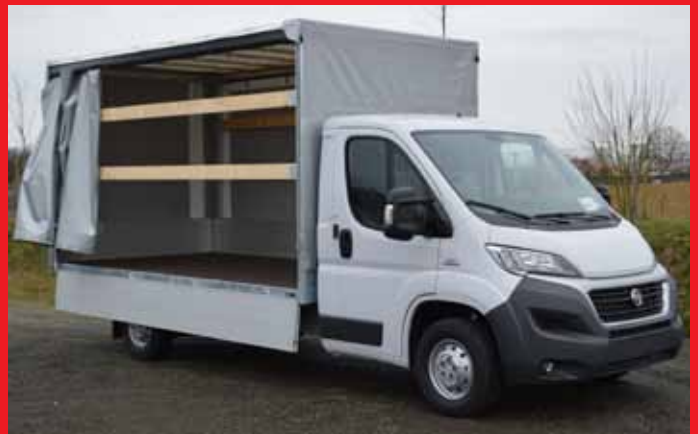
Ausführung mit Plane und Spriegel sowie Schiebeplane.
