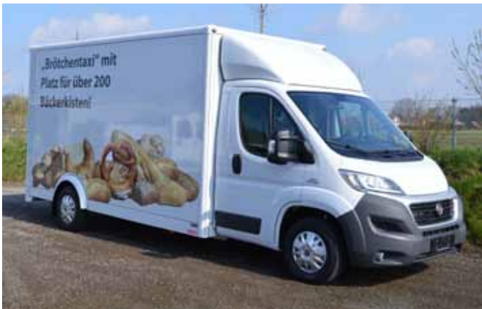
Tiefrahmenkoffer „Bäcker“ mit 3.500 kg und Auffahrrampe.
