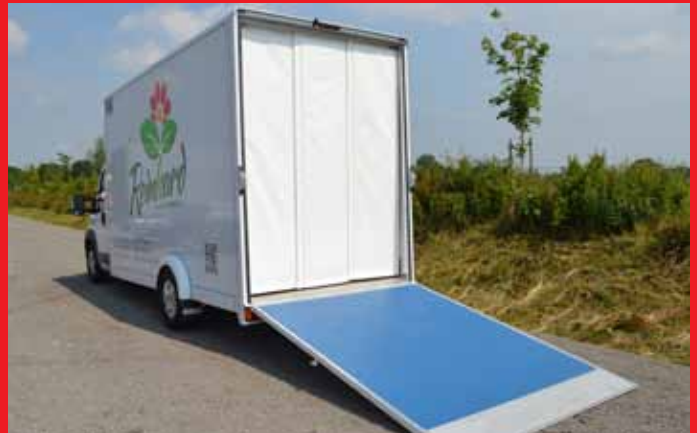
Auffahrrampe und geschlossener 3-teiliger Isoliervorhang.
