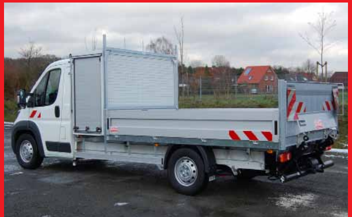
Ausführung mit Werkzeugschrank und klappbarer 750 kg LBW.
