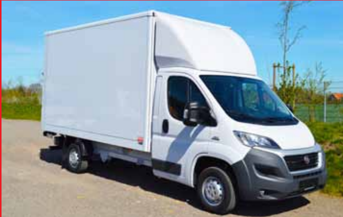
LBK-Sandwichkofferaufbau mit 3-D GFK-Dachspoiler.
