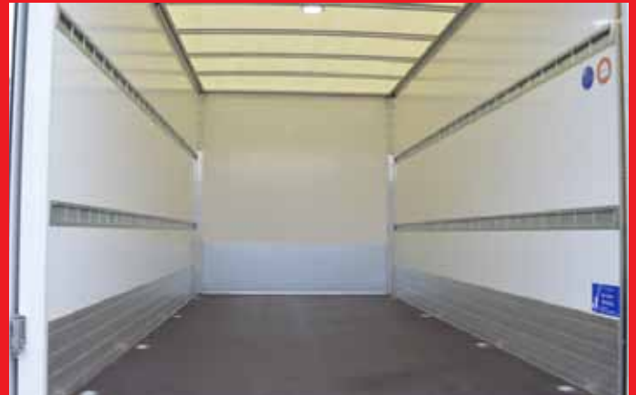
2 Reihen versenkte Stäbchen-Zurrschienen und Zurrösen.
