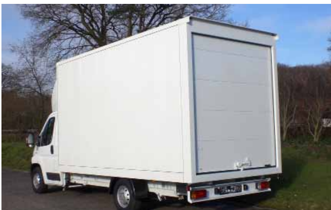
SWK-Sandwichkofferaufbau mit Cargo-Rolltor.
