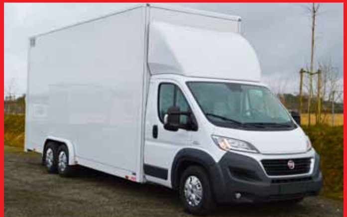
Ausführung extralang 6.000 mm und extrahoch 2.650 mm i.L.
