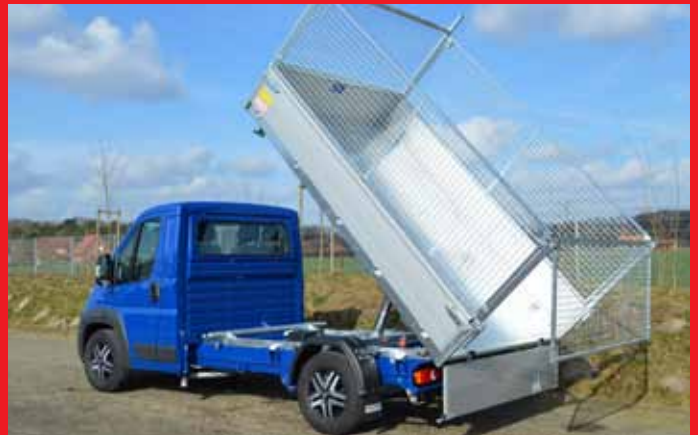
Ausführung mit Gitteraufsatz 1000 mm hoch.
