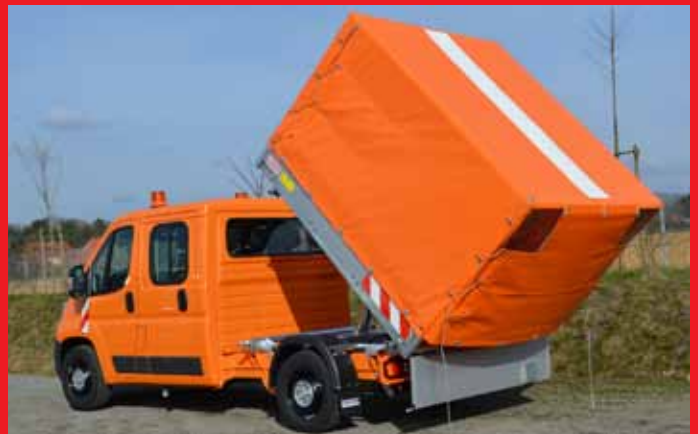
Ausführung mit Planengestell / Plane und Vorwarnleuchten.
