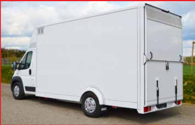
Ausführung heckseitige Auffahrrampe mit Gasdruckfedern.
