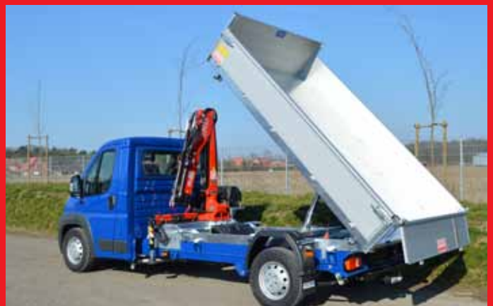
Ausführung mit vorderen Ladekran Fassi Micro 25.
