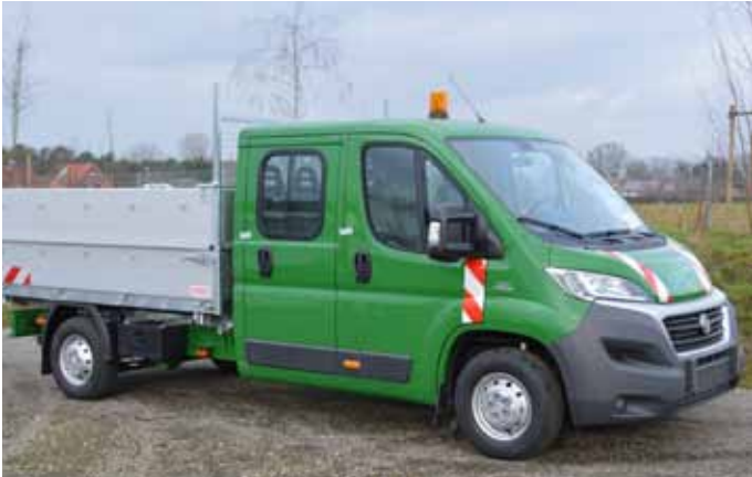
Ausführung mit Aluminium Pendelaufsatz 400 mm und RKL.
