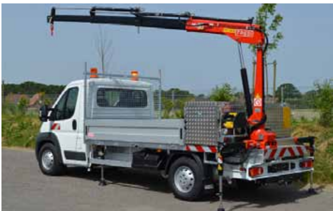
Ausführung mit Aluminium Staubbox und Heck-Ladekran.
