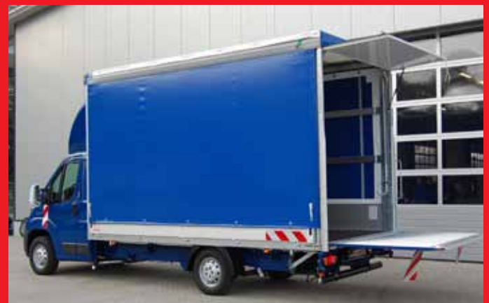
Ausführung mit Schiebeplane, Schiebedach und 750 kg LBW.
