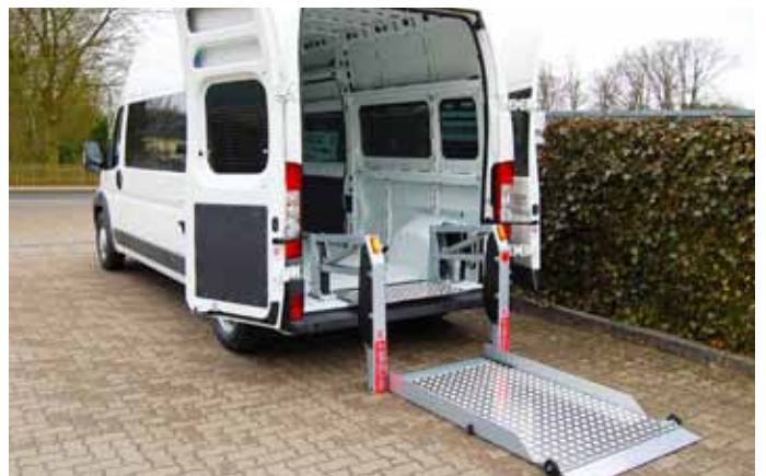
Tragkraft 400 kg mit Plattformmaße 1380 x 920 mm (LxB).
