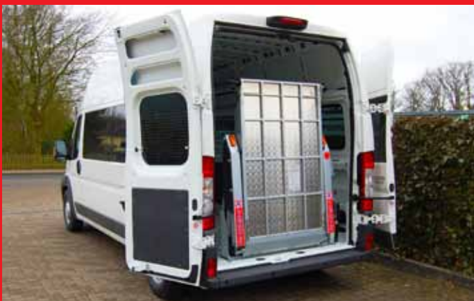
Kastenwagen Linearlift für Frachten und Rollstühle geeignet.
