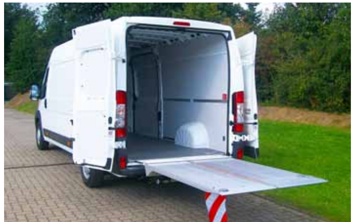
Ausgeklappt mit Plattformmaße 1610 x 1330 mm (LxB).
