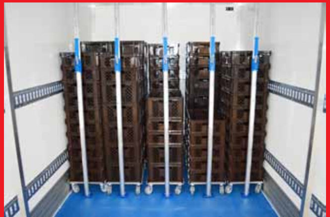
28 Stellplätze (620 x 420 mm) und Boden-Decke-Arretierung.
