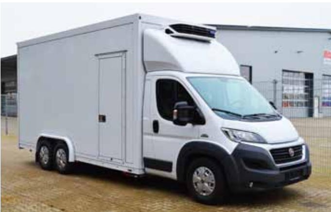
Ausführung 5.000 kg mit Isoaufbau und Kühlmaschine.
