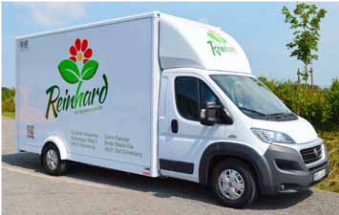
Tiefrahmenkoffer „Gärtner“ mit 3.500 kg (4.500 kg) zGG.
