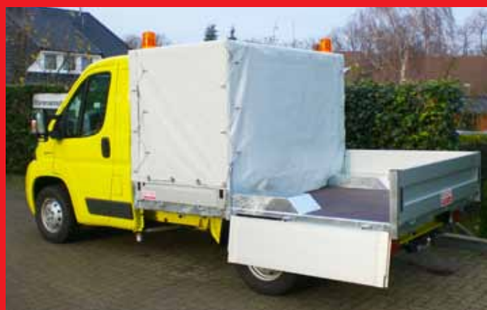
Tiefpritsche Typ TA mit geteilten Bordwänden und halbe Plane.
