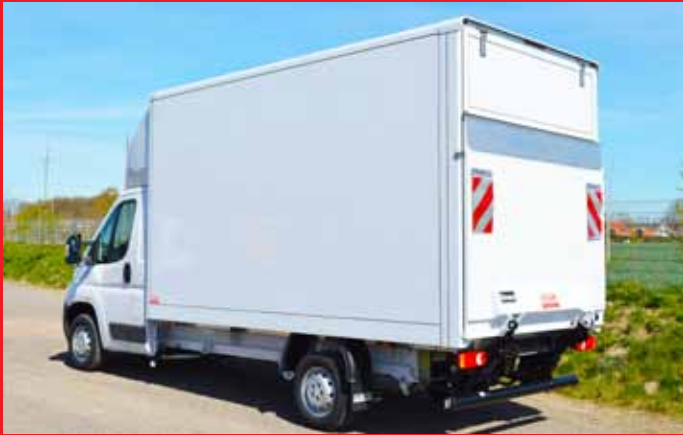
LBK-Sandwichkofferaufbau mit 750 kg Ladebordwand.
