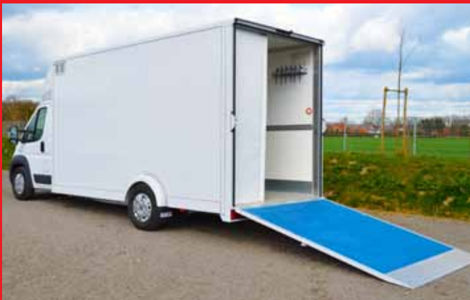
Standardauffahrrampe 600 kg und 3-teiliger Isoliervorhang.
