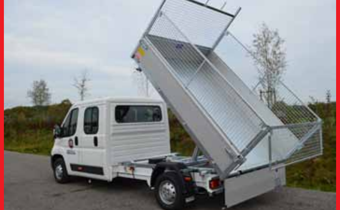
Ausführung mit Stirnwandgitter und Gitteraufsatz 600 mm.
