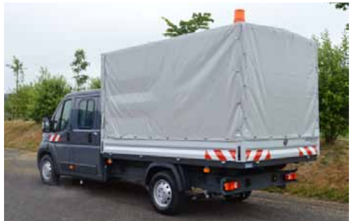
Werkspritsche mit Planengestell und Rundumkennleuchte.
