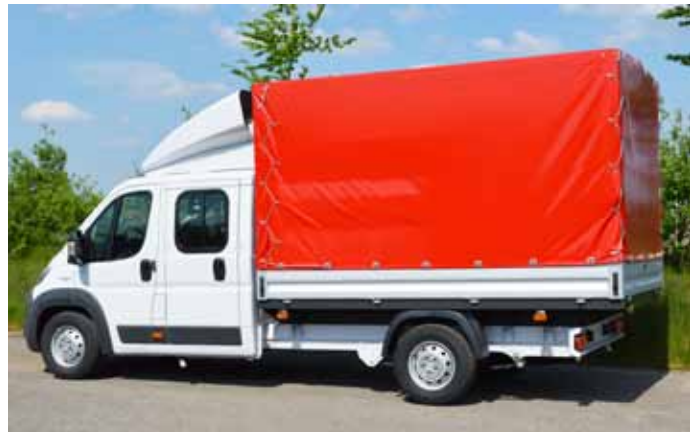
Werkspritsche mit Planengestell und 3D-Dachspoiler für Doka.
