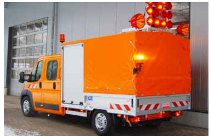
Ausführung mit RKL, Vorwarnblitzer und Schwenkleuchtpfeil.
