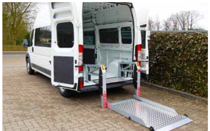
Tragkraft 400 kg mit Plattformmaße 1380 x 920 mm (LxB).
