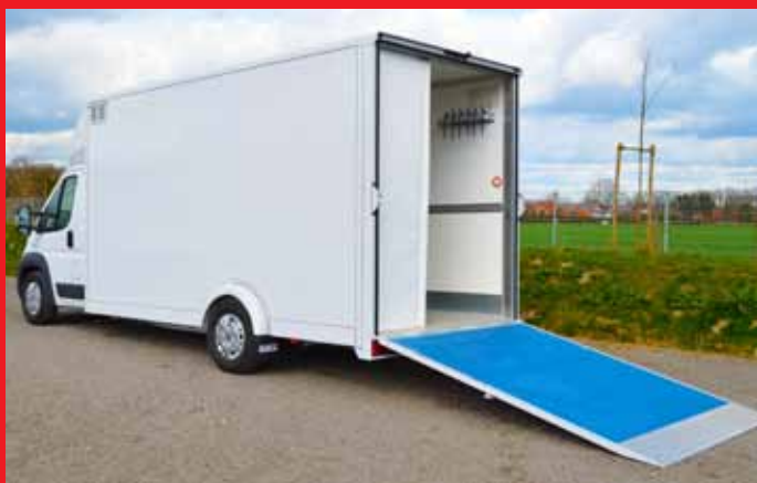
Standardauffahrrampe 600 kg und 3-teiliger Isolievorhang.
