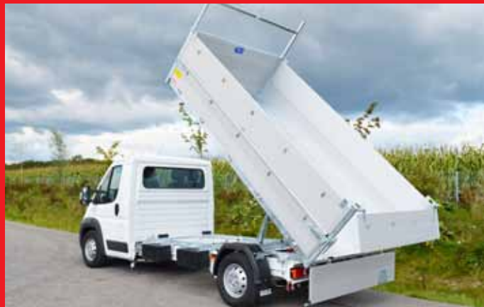
Ausführung mit Stirnwandgitter und Aluaufsatz 400 mm.
