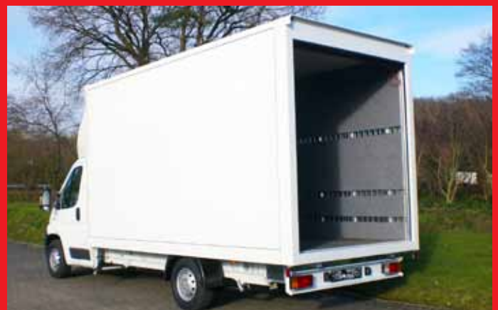
3 versenkte Stäbchenzurrlasten und Nadelfilzauskleidung.
