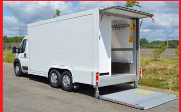
Ausführung mit Hebebühne für Palettenbeladung.
