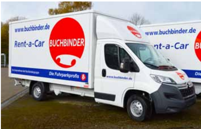
ALK-Alukofferaufbau mit Sonder-metallic Lackierung.
