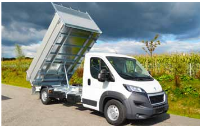
Ausführung mit Aluminium Pendelaufsatz 400 mm.
