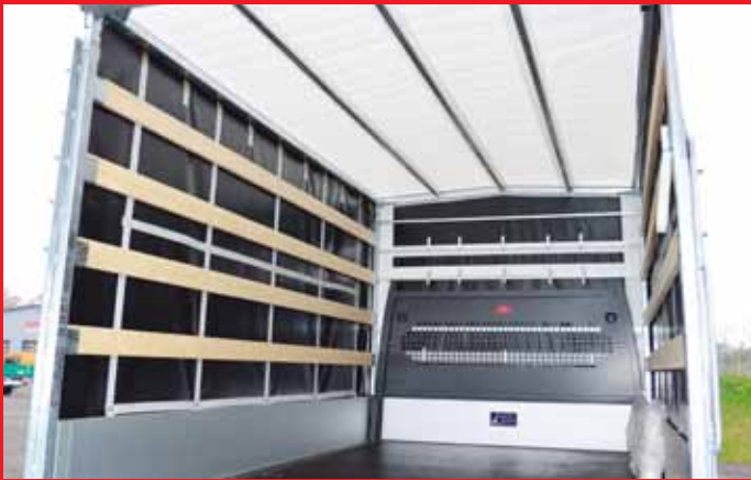
Werkspritsche mit Planengestell und seitlicher Schiebefläche.
