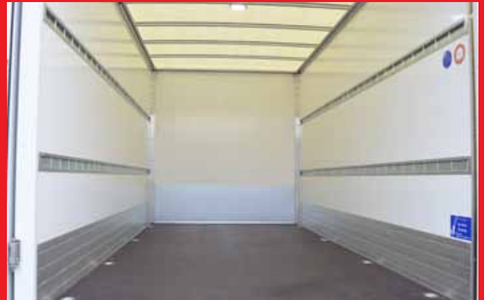
2 Reihen versenkte Stäbchen-Zurrschienen und Zurrösen.
