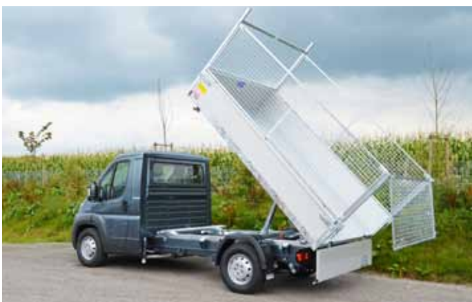
Ausführung mit Laubgitteraufsatz in 1000 mm Höhe.
