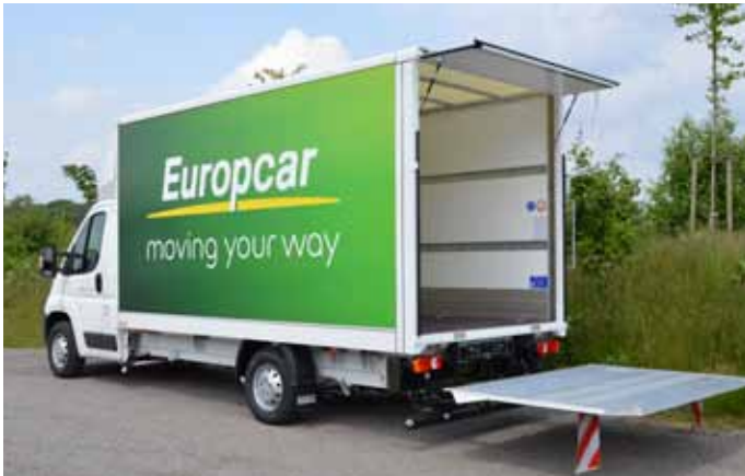
LBK-Sandwichkofferaufbau mit 750 kg Ladebordwand.
