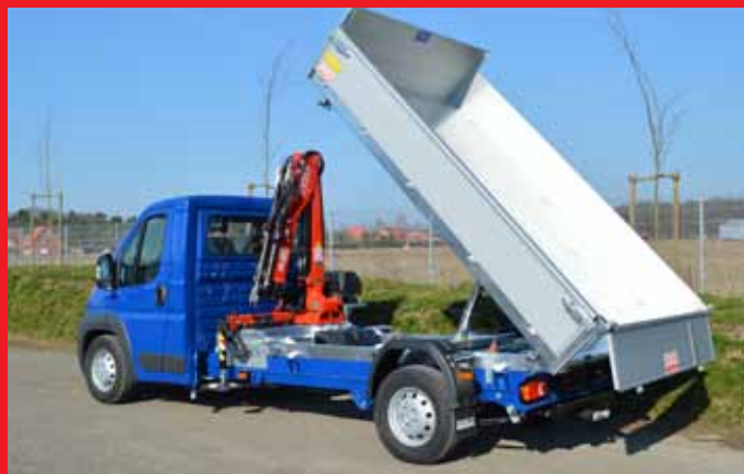
Ausführung mit vorderen Ladekran Fassi Micro 25.
