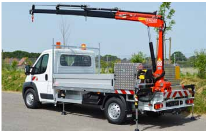
Ausführung mit Aluminium Staubox und Heck-Ladekran.
