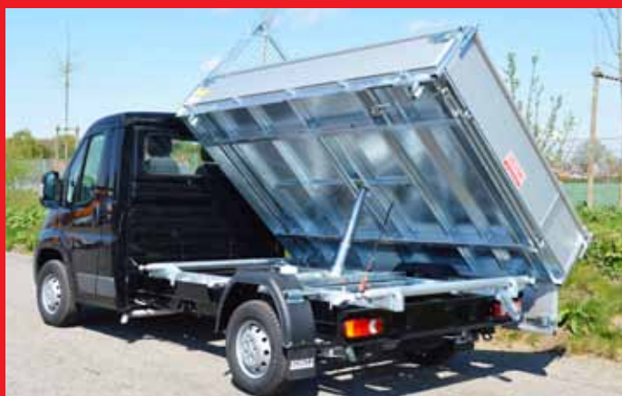
Dreiseitenkipper Typ DK mit feuerverzinktem einteiligen Boden.
