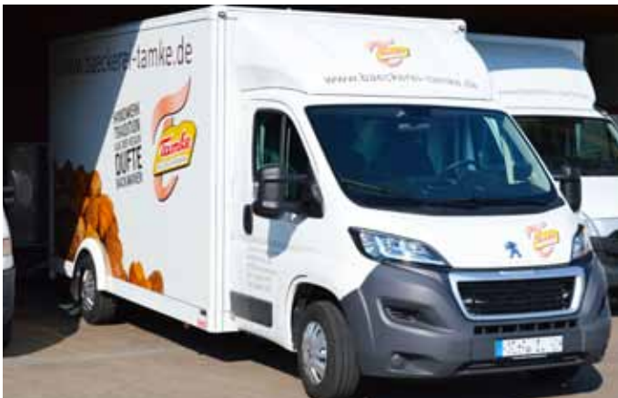
Tiefrahmenkoffer „Bäcker“ mit 3.500 kg und Auffahrrampe.
