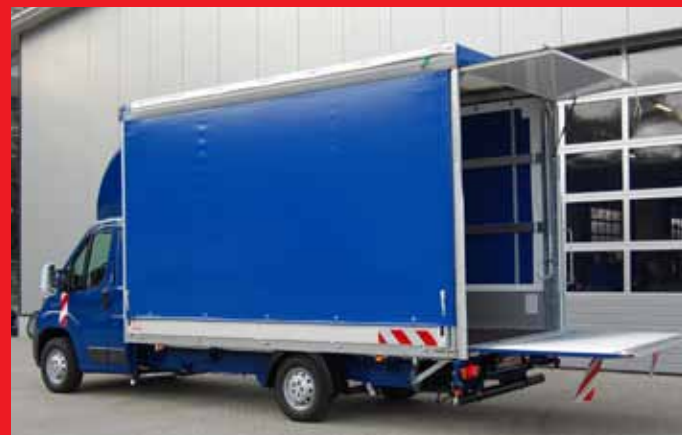
Ausführung mit Schiebeplane, Schiebedach und 750 kg LBW.
