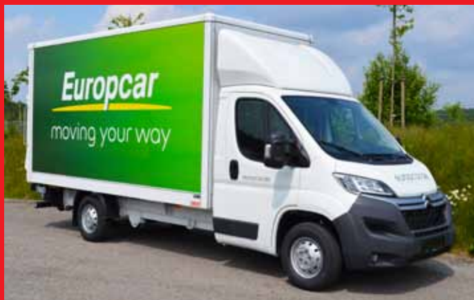
LBK-Sandwichkofferaufbau mit 3-D GFK-Dachspoiler.
