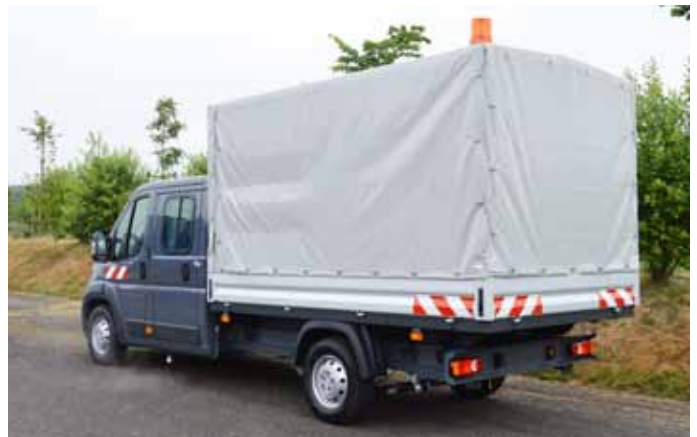
Werkspritsche mit Planengestell und Rundumkennleuchte.
