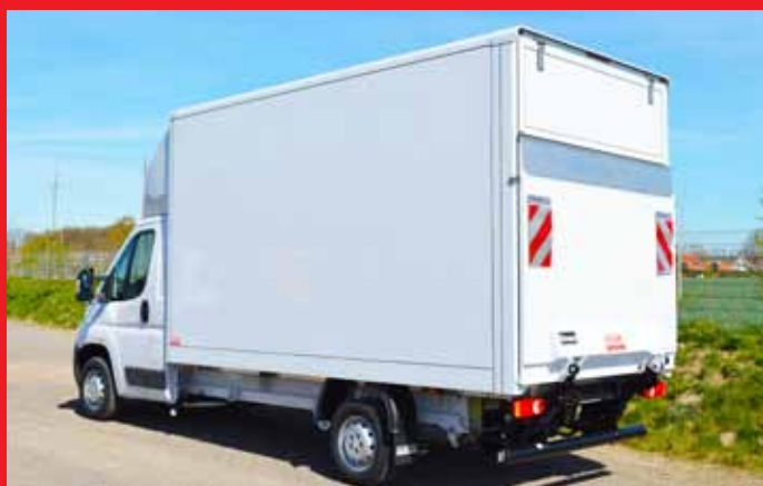
LBK-Sandwichkofferaufbau mit 750 kg Ladebordwand.
