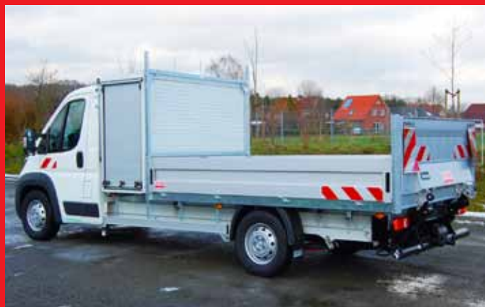
Ausführung mit Werkzeugschrank und klappbarer 750 kg LBW.
