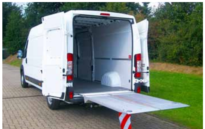
Ausgeklappt mit Plattformmaße 1610 x 1330 mm (LxB).
