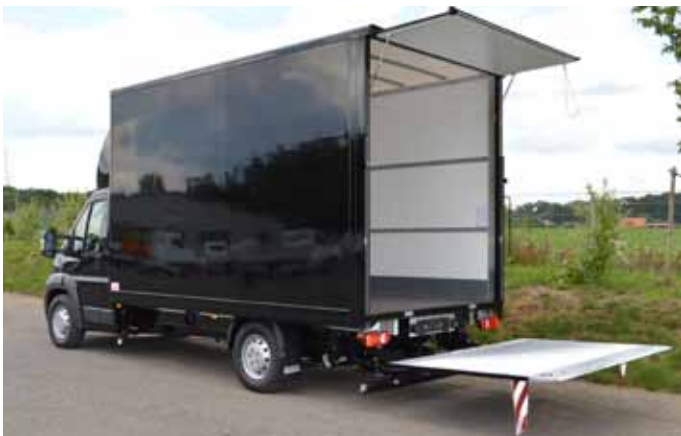
LBK-Sandwichkofferaufbau mit 750 kg Ladebordwand.
