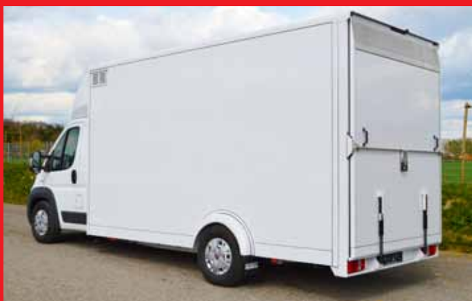
Ausführung heckseitige Auffahrrampe mit Gasdruckfedern.
