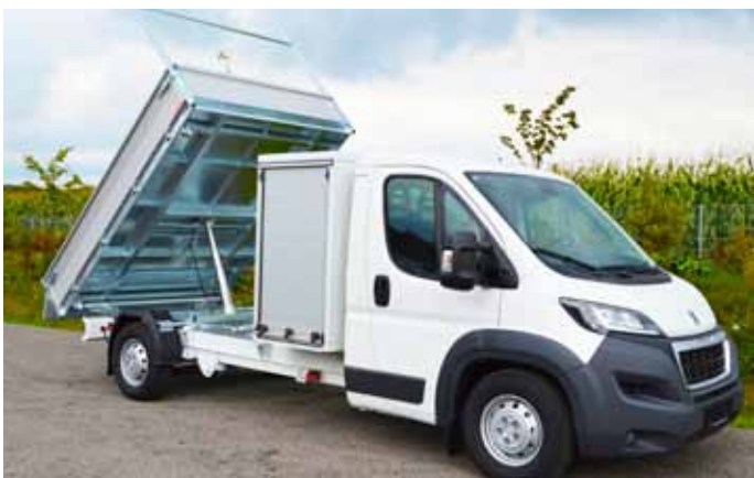
Ausführung mit Rollo-Werkzeugschrank und verkürzten Aufbau.
