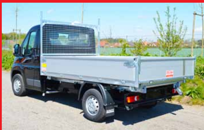
Spezielle Kipperbordwände mit oberer Verstärkung.
