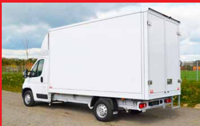
LBK-Sandwichkoffer mit Standardausführung „Hecktüren“.
