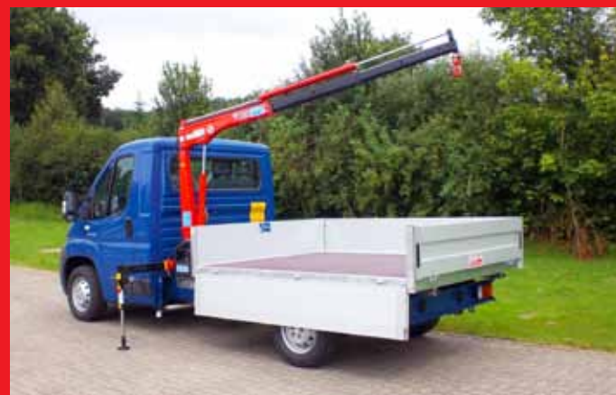
Ausführung mit verkürztem Aufbau und Ladekran vorn.
