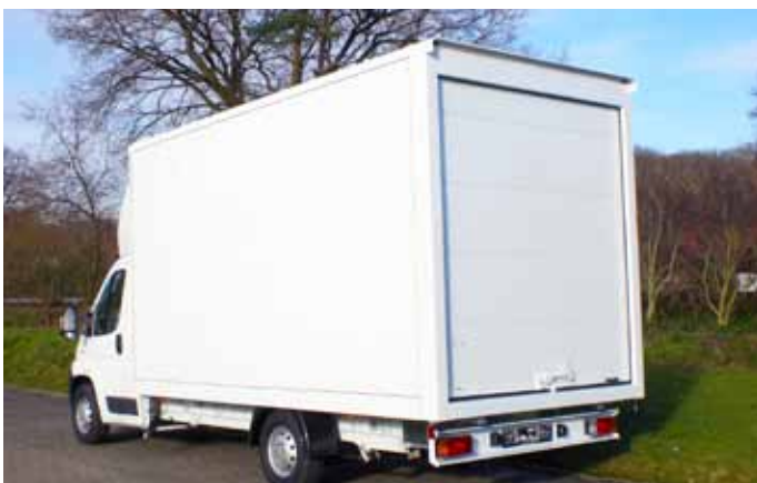
SWK-Sandwichkofferaufbau mit Cargo-Rolltor.
