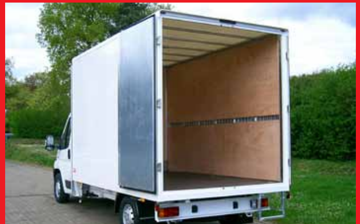
ALK-Alukofferaufbau mit Innenverkleidung 6 mm Sperrholz.
