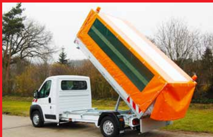
Ausführung „Häcksel-Planengestell“ mit Luftgitter und RKL.
