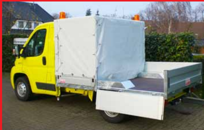
Ausführung mit geteilten Bordwänden und halbe Plane.
