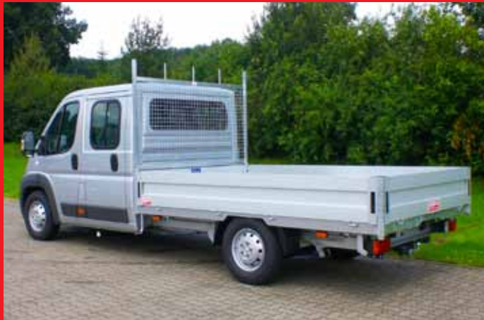
Standardbordwand mit Sickenprofil. Glatte Bordwand o. Mehrpr.
