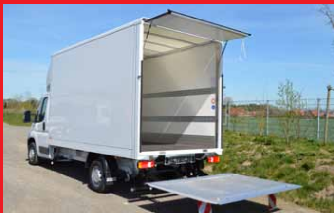
2 Reihen versenkte Kombi-Zurrschienen und Aluscheuerleisten.
