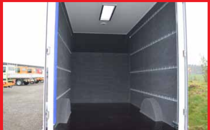
Versenkte Stableisten und Nadelfilz-Auskleidung für Möbel.
