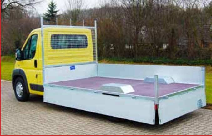
Tiefpritsche Typ TA mit Radkästen, komplett feuerverzinkt.
